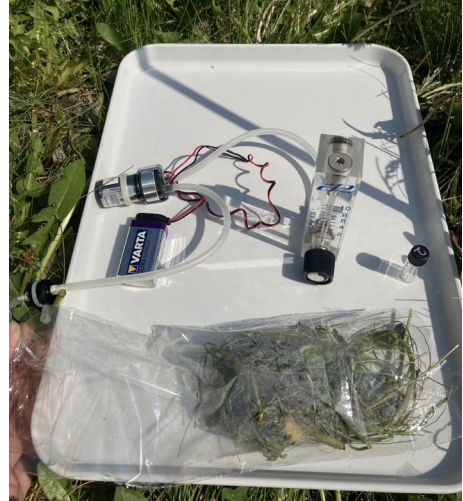
Abb. 5: Mittels batteriebetriebener Membranpumpe (links oben im Bild) und eines Durchflussreglers (rechts oben im Bild) wurde aus dem Grasschnitt der Grasfalle, welcher in einem Bratschlauch verpackt wurde (unten im Bild), für 5 Minuten bei einer Durchflussrate von 200 ml/min die mit Grasduft angereicherte Luft gesaugt. Am Schlauchende befand sich eine Duftfalle, an die die emittierten Duftstoffe gebunden wurden. Foto: K. Wechselberger.
